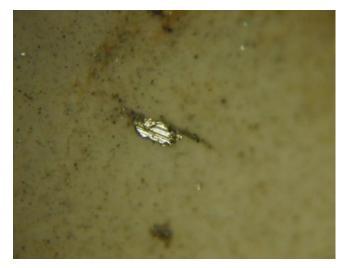
150 micron ferrous fatigue chunk
